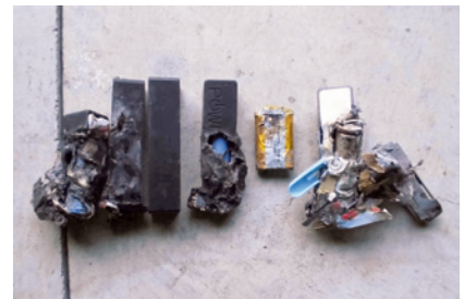
実際に出火した充電式電池の一部
