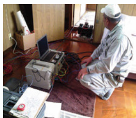
ビック動的診断測定状況
