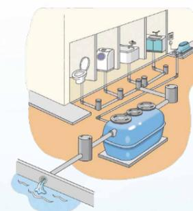
単独処理浄化槽から合併処理浄化槽に付け替えると、放流される汚れが単独処理浄化槽に比べて8分の1になり、環境汚染を大幅に削減できますので、下水道が整備されない区域の人は合併処理浄化槽への切り替えをお願いします。
