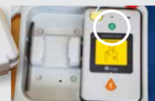
AEDを開き、電源ボタンを押す。電源が入るとガイド音声流れる。
