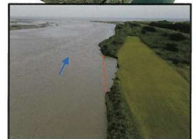
令和2年7月豪雨による河岸侵食 (令和2年7月 吉田町川岸地先)
